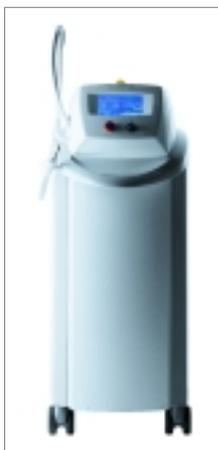
ist so kurz, dass die Reaktionsschwelle der Nerven nicht erreicht wird. Effektive Keimabtötung und schnelle Wundheilung sind selbstverständlich. Der KaVo KEY-Laser 3 arbeitet mit einer Wellenlänge von 2.940 nm und einer Pulsfrequenz von 1 bis 25 Hz je Wellenlänge.
