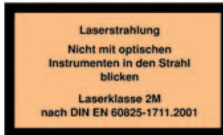
Abb. 2: Laserwarnschild (oben) und ein Beispiel für ein Hinweisschild (unten).
