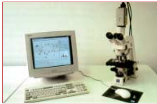
Abb. 8: Instrumentarium für die interaktive DNA-Bildzytometrie: AUTOCYTE QUCI DNA workstation (TriPath Inc., Burlington, N.C., USA), bestehend aus einem Zeiss Axioskop mit einer CCD-Farbkamera, Pentium-PC, Monitor, Tastatur und Maus.
