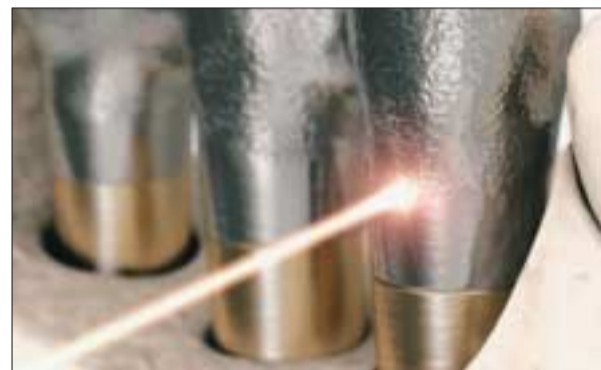
Laser-Verbindung einer mit der Cresco-Technologie präzisierten Brücke.
