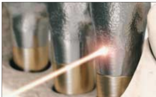
Laser-Verbindung einer mit der Cresco-Technologie präzisierten Brücke.
