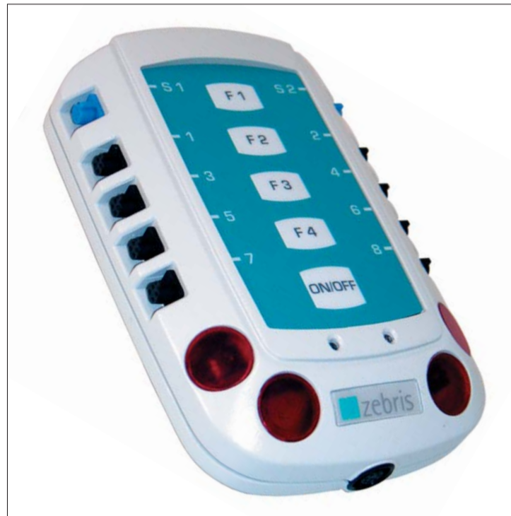
Modernes, praxissgerechtes EMG-Gerät der Fa. Zebris mit kabelloser Bluetooth-Anbindung an den PC.
