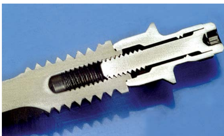
Abb. 5: Schliffpräparat eines zusammengesetzten enossalen Implantates. – Abb. 6: Röntgenbild von zusammengesetzten enossalen Implantaten, die Hohlräume in den Implantaten und den Suprastrukturen sind durch Pfeile markiert. – Abb. 7: Übergang zwischen Implantat und dazugehörigem Abutment in verschiedenen Vergrößerungen.
