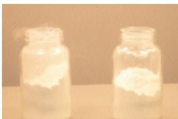
Vergleich konventionelle (l) und staubarme Einbettmasse (r)
