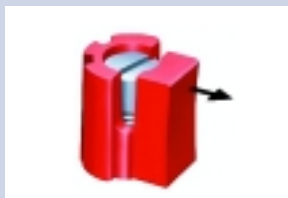
Wird die Schraube weiter eingedreht, beginnt die stufenlose Friktionseinstellung.
