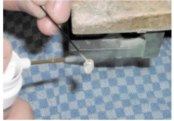
Abb. 13: Der Silberlack wird heutzutage wegen seiner dünnen und gleichmäßigen Schicht meist aufgesprüht.
