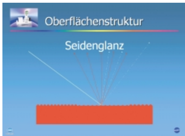
Abb. 4: Strukturierte Zahnoberflächen streuen das Licht in verschiedene Winkel und erlauben den Einblick in die Tiefe.
