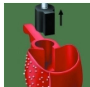
Abb. 4: Der Platzhalter kann mit Hilfe des Gewindestiftes herausgezogen werden. Die Modellation wird nun eingebettet und gegossen.
