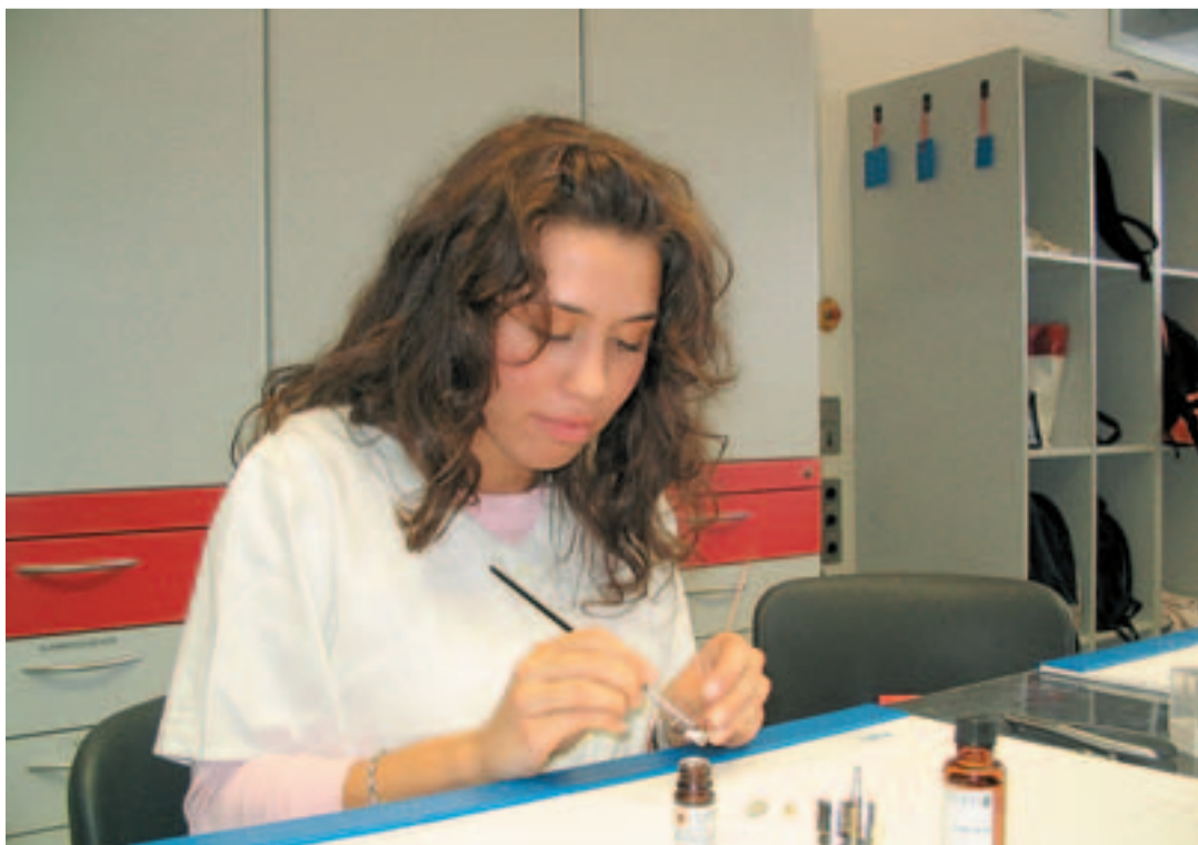
Eine Schülerin beim Beschichten ihres Stumpfes mit Silberlack. Erst dann kann das Werkstück in das Galvanobad.
