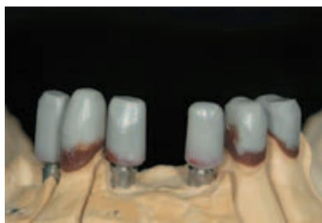
Abb. 8: Gefräste Wachmodellation der Primärkronen mit 2°-Konuswinkel.
