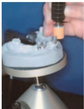
Abb. 2: Das Primärteil wird mit Conofix bearbeitet.
