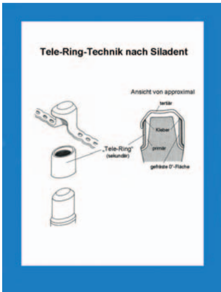
Abb. 1: TeleRing-Technik nach SILADENT, schematisch dargestellt.
