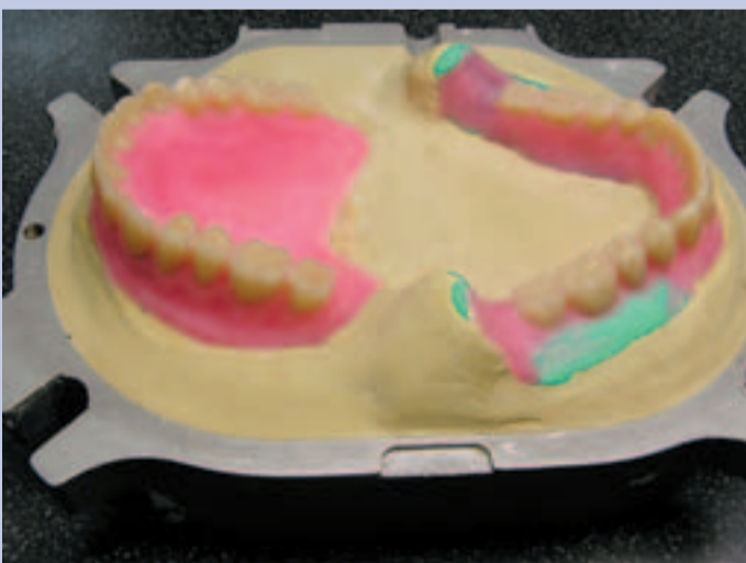
Abb. 15: Beide Modelle werden mit dem jeweiligen Einbettssystem, in unserem Fall die Palajet-Doppelkübette, eingebettet.
