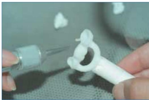
Abb. 5: Das Keramikgerüst wird mit 50 µ bei 1,5 bis 2,0 bar abgestrahlt.
