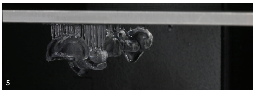
Abb. 5: Bohrschablone mit Stützstrukturen im 3D-Drucker.
