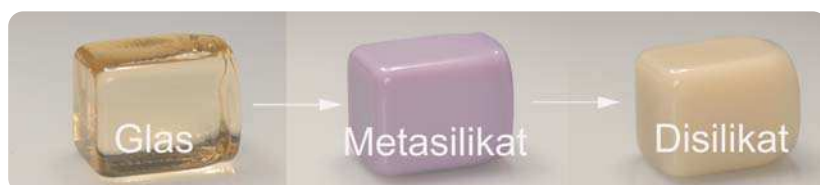
Abb. 1: Lithium-Disilikat-Keramikblöcke zeichnen sich durch ihre hohe Biegefestigkeit aus (Darstellung der drei verschiedenen Kristallisationsstufen).
