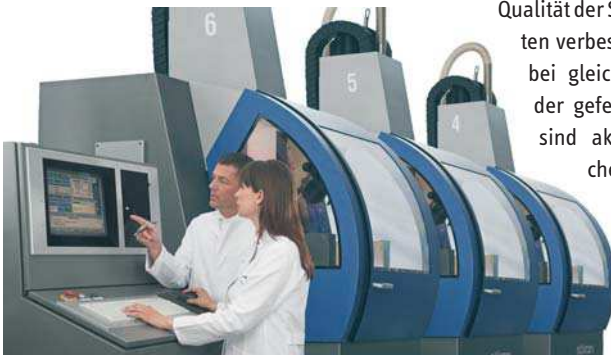
Abb. 5: Zur Bearbeitung von ZrO_2 -Keramik für Kronen- und Brückengerüste verfügen Fräszentren über eine ausgeklügelte Qualitätssicherung. (Foto: etkon-Straumann)
