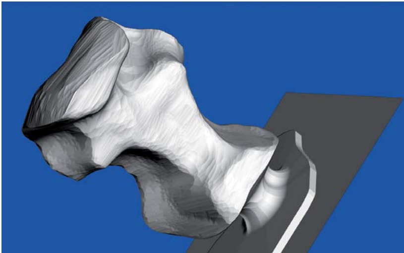
Abb. 2: Computergenerierte überdeutliche Darstellung der Fräsbahnen: Die Restaurationsform wird mittels rotierender Instrumente aus einem industriellen Keramikblock herausgeschliffen.
