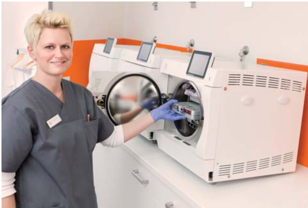
Abb. 5: Auch verpackte Instrumente, zum Beispiel in Kassetten, werden sehr schnell in dem Autoklaven Vacuklav 40 B+ sterilisiert. – Abb. 6: Thermodesinfektoren zur besseren Ergonomie auf Unterschränken. Reiner Bereich rechts.
