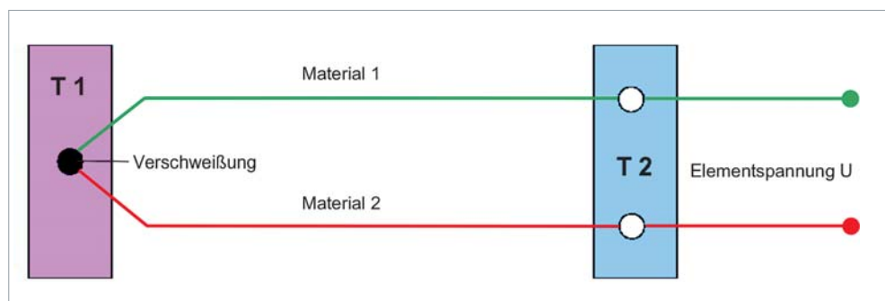
Abb. 1: Prinzipaufbau eines Thermoelementes.
