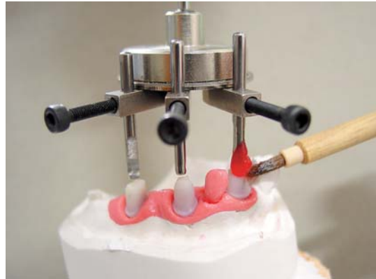
Abb. 4: Ohne langes Warten: Die Metallarme des Telemaster werden über den Teleskopen ausgerichtet. Die Pins werden abgesenkt und mit Pattern Resin-Kunststoff an den Teleskopen befestigt. Im Vergleich mit starren Übertragungsspinnen ist die Zeitersparnis enorm.
