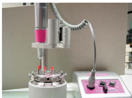
Abb. 12: Die Kunststoffkappchen werden mit einer geeigneten Technikmaschine bearbeitet. Über Adapter kann Telemaster-mill mit den Technikmaschinen aller gängigen Hersteller kombiniert werden.
