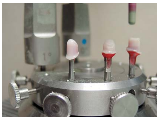
Abb. 10: Nur mit Gummi: Die Primärteile werden auch hochglanzpoliert. Damit sie den 1°-Winkel behalten, hat der Telemaster Abziehsteine mit definierten Winkeln.
