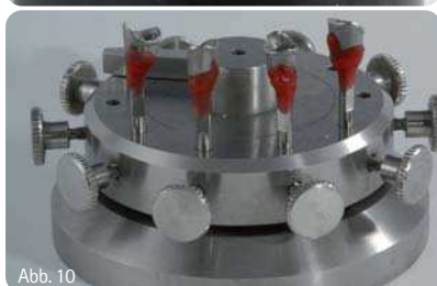
Abb. 8: Das Sägemodell mit den Innenkoni auf dem Modellträger. – Abb. 9: Mit Pattern Resin werden die Konuskronen fixiert. – Abb. 10: Die Pins werden in die Bohrungen des Außenrings gesteckt. – Abb. 11: Das Lumen der Kronen wird mit Pattern Resin ausgefüllt. – Abb. 12: Jeder Innenkonus ist frei zugänglich und kann problemlos bearbeitet werden.
