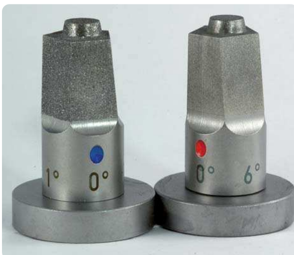
Abb. 17: Die Abrichtblöcke für die Teleskop- und Konuskronen-Polierer. – Abb. 18: Abrichten des braunen Vorpolierers auf 2°. – Abb. 19: Abrunden des Polierers für das Bearbeiten der Hohlkehle.
