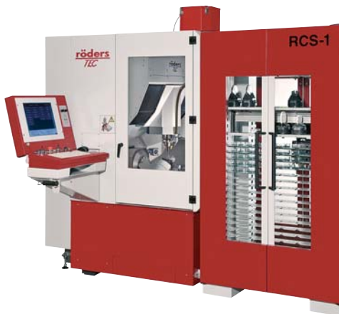
Oben: Die RXP 500 DS Hochgeschwindigkeitsfräsmaschine. – Rechts: Innenraum der RXP 500 DS.
