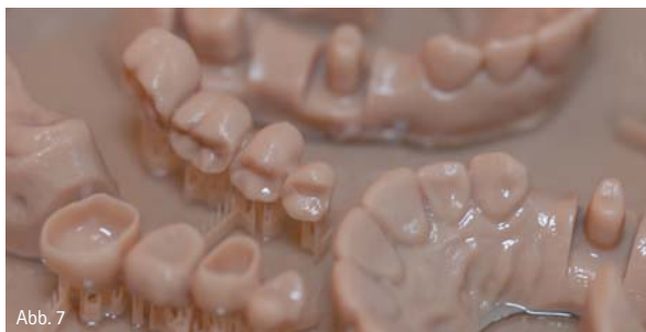
Abb. 1–4: Alles wird in einem Prozess gefertigt. – Abb. 5: Baukastensystem mit Metall-Pin. – Abb. 6–7: Die Objekte direkt nach der Fertigung und Reinigung. – Abb. 8: Die zu erreichende Präzision liegt unter 30 \mu .
