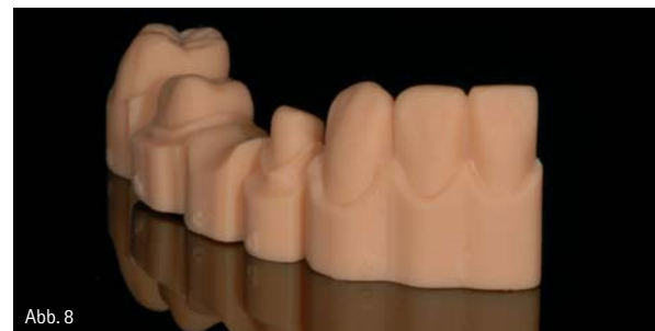
Abb. 1–4: Alles wird in einem Prozess gefertigt. – Abb. 5: Baukastensystem mit Metall-Pin. – Abb. 6–7: Die Objekte direkt nach der Fertigung und Reinigung. – Abb. 8: Die zu erreichende Präzision liegt unter 30 \mu .
