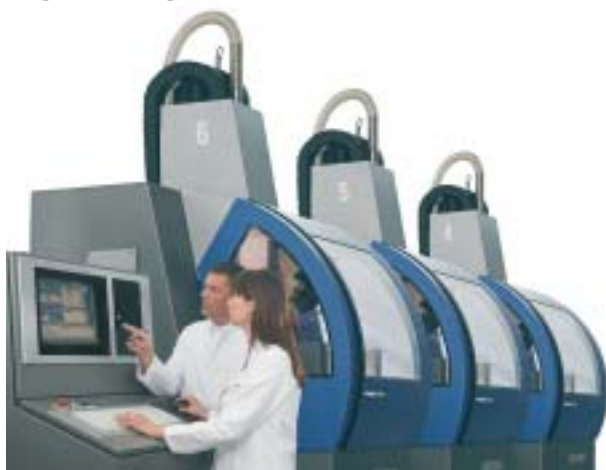
Abb. 2: Zur Bearbeitung von ZrO 2 -Keramik für Kronen- und Brückengerüste verfügen Fräszentren über eine ausgeklügelte Qualitätssicherung. (Foto: etkon-Straumann)
