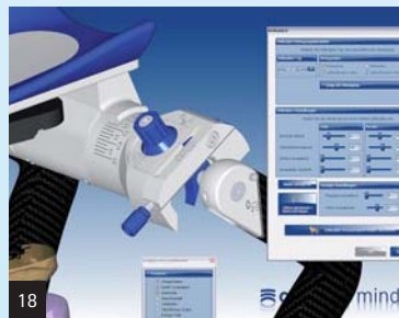
Abb. 17: Einstellen der patientenspezifischen Gelenkbahnneigung. – Abb. 18: Die Einstellungen werden grafisch animiert in Echtzeit am Ceramill Artex® nachvollzogen. Somit entsprechen sie auch optisch denen des realen Artikulators. – Abb. 19: Anhand der eingestellten Artikulatorparameter, wie SKN, Benettwinkel, ISS und des individuellen Frontzahnführungstellers, wird die Bewegungssimulation durchgeführt.
