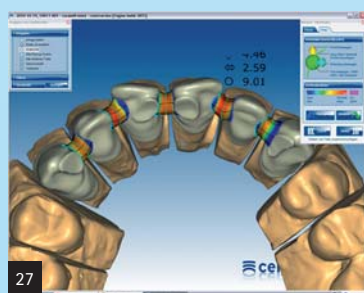
Abb. 26: Das Gerüst wird mit einem für die Schichtstärke der Verblendung benötigten Abstand automatisch reduziert. Die ausgewählten Führungsflächen bleiben hierbei erhalten. – Abb. 27: Die Verbindergestaltung für die verblockten Kronen erfolgt individuell unter Berücksichtigung der materialspezifischen Minstdurchmesser. – Abb. 28: Datensatz der fertigen Brückenkonstruktion.
