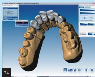
Abb. 23: Die bei der dynamischen Anpassung an den Antagonisten vorliegenden Stör- bzw. Kontaktstellen der Modellierung werden automatisch entfernt. – Abb. 24: Die entstandenen Führungsflächen sind deutlich zu erkennen. – Abb. 25: Es werden die Zahnanteile markiert, die als Führungsflächen erhalten bleiben sollen. An diesen Bereichen wird das Gerüst später reduziert.
