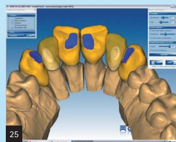
Abb. 23: Die bei der dynamischen Anpassung an den Antagonisten vorliegenden Stör- bzw. Kontaktstellen der Modellierung werden automatisch entfernt. – Abb. 24: Die entstandenen Führungsflächen sind deutlich zu erkennen. – Abb. 25: Es werden die Zahnanteile markiert, die als Führungsflächen erhalten bleiben sollen. An diesen Bereichen wird das Gerüst später reduziert.
