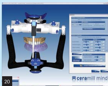
Abb. 20: Die Bewegung erfolgt sowohl für die linke und rechte Laterotrusion als auch der Pro- und Retrusion. – Abb. 21: Die Bewegungsabläufe erfolgen unter Berücksichtigung der eingegebenen Werte des individuellen Frontzahnführungstellers. – Abb. 22: Erneut erfolgt die Darstellung der Kontaktbereiche an den modellierten Zähnen.
