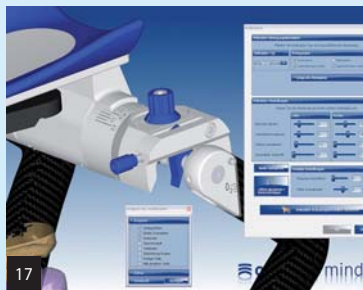
Abb. 17: Einstellen der patientenspezifischen Gelenkbahnneigung. – Abb. 18: Die Einstellungen werden grafisch animiert in Echtzeit am Ceramill Artex® nachvollzogen. Somit entsprechen sie auch optisch denen des realen Artikulators. – Abb. 19: Anhand der eingestellten Artikulatorparameter, wie SKN, Benettwinkel, ISS und des individuellen Frontzahnführungstellers, wird die Bewegungssimulation durchgeführt.
