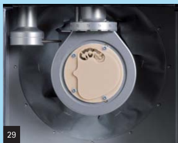
Abb. 29: PMMA-Rohling mit den in der Ceramill Motion geätzten Gerüsten. – Abb. 30: Brückengerüst auf dem realen Modell. Die Führungsbereiche sind deutlich zu erkennen. – Abb. 31: Die geführte Bewegung erfolgt exakt an den virtuell konstruierten Führungsflächen des Brückengerüsts. Optimaler Schutz für die Restbezahnung ist somit gewährleistet.
