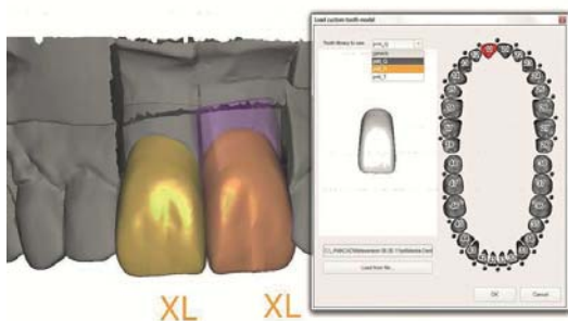
Das Designen geht relativ einfach und schnell von der Hand. Die CAD-Software gibt einen Vorschlag vor, den der Zahntechniker funktional und ästhetisch optimiert.
