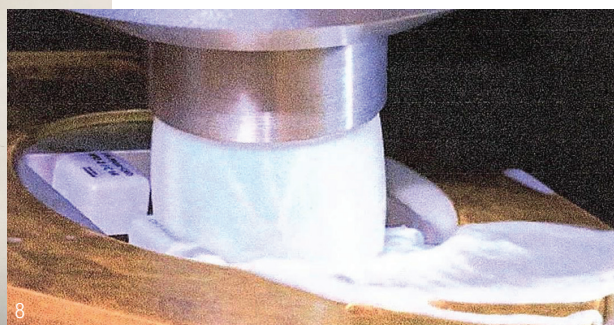
Abb. 7: Gefräste Schienen aus klarem Kunststoff (PMMA). Abb. 8: Schwallkühlung der Gamma 202-5D.
