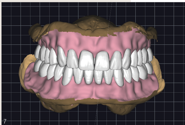
Abb. 7: Konstruktion der neuen Prothesen in der exocad-Software.
