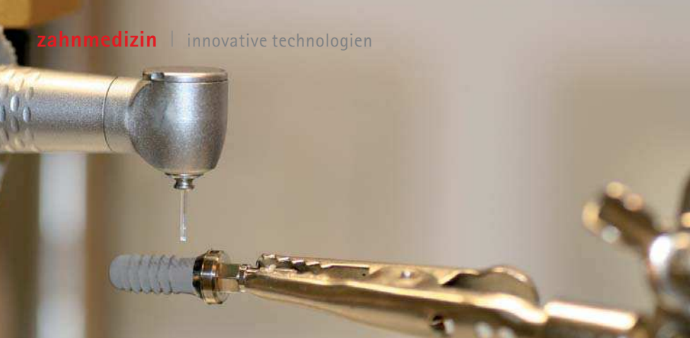
Abb. 4: Versuchsaufbau: simulierte Periimplantitisbehandlung im zahntechnischen Stativ.
