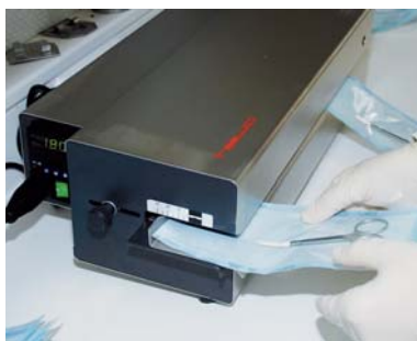
Abb. 1: Einlegen der Verpackungen in ein normkonformes Durchlaufsiegelgerät (hawodent hd 680 DE-V/hd 680 DEI-V, validierbar und mit Schnittstelle zur Softwareanbindung).
