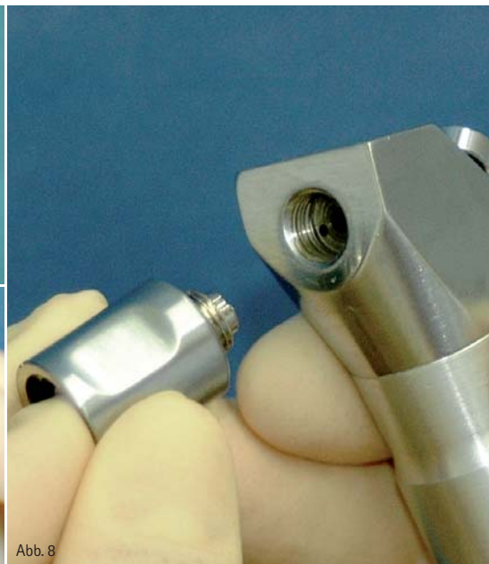
Abb. 6: Auch für Ihre MFS (mit nur ganz wenigen Ausnahmen) gibt es den passenden Adapter. – Abb. 7: Mit einem normalen Schraubendreher wird der alte Ansatz abgeschraubt ... – Abb. 8: ... und der Adapter aufgeschraubt. – Abb. 9: Danach verriegeln Sie den Pro-Tip Einweg-Ansatz durch eine Drehung auf der MFS. – Abb. 10: So exakt gearbeitet ist das Innenleben des Pro-Tip.
