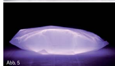
Abb. 4: Mit speziellem Gasgemisch gefüllter Beutel. – Abb. 5: Durch Anlegen einer Hochspannung zu Plasma aktiviertes Gasgemisch.
