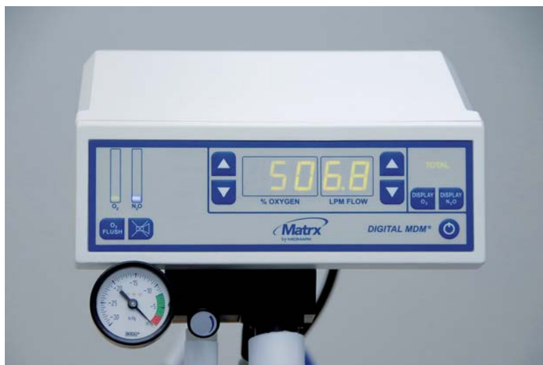
Abb. 1: Digitaler Matrix Lachgasmischer.
