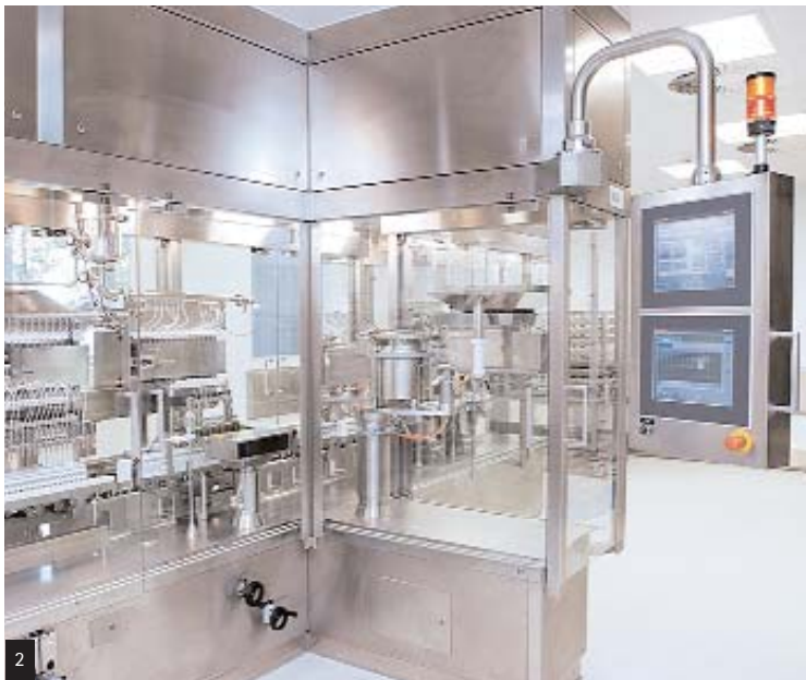
Abb. 2: Hochmoderne Abfüllanlage für Lokalanästhetika. – Abb. 3: Mitarbeiter bei der optischen Kontrolle der etikettierten Glaszylinder. – Abb. 4: Etikettierung der Metalldosen.
