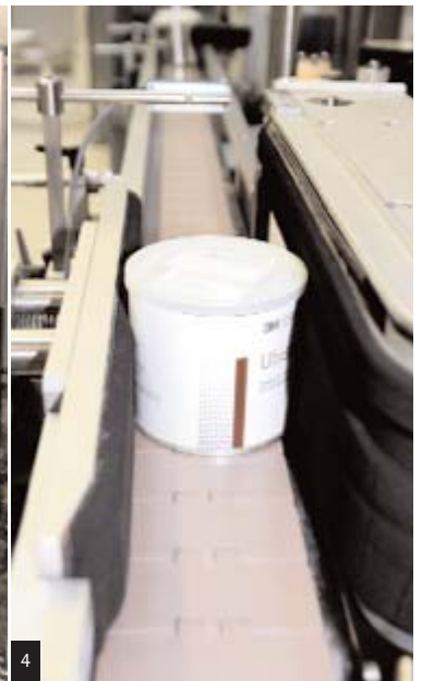
Abb. 2: Hochmoderne Abfüllanlage für Lokalanästhetika. – Abb. 3: Mitarbeiter bei der optischen Kontrolle der etikettierten Glaszylinder. – Abb. 4: Etikettierung der Metalldosen.
