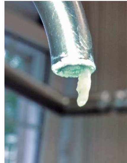
Biofilme in Trinkwasserinstallation und in dentaler Behandlungseinheit
