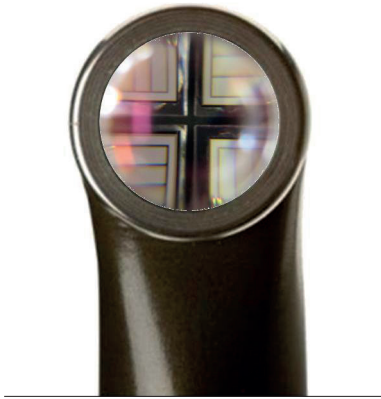
Die vier LEDs im niedrigen Kopf der VALO erzeugen drei verschiedene Wellenlängen. Eine Sammellinse bündelt das Licht zu einem homogenen Lichtstrahl, der kaum auffächert.
