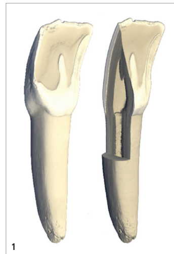
Abb. 1: Mikro-Computertomografie eines vollständigen Zahns, der Anschnitt daneben zeigt innere Strukturen. – Abb. 2: Mikro-CT-Schnitt desselben Volumens zeigt die Absorption (oben). Darunter sind Intensitätsverteilungen der Fluoreszenzmessungen von Phosphor, Kalzium und Zink dargestellt. Während die Hauptbestandteile Kalzium und Phosphor homogen verteilt sind, steigt die Zinkkonzentration in Richtung Pulpa an.
