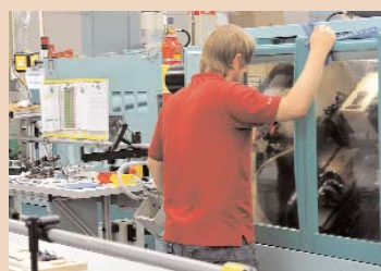
Modernste CNC-Automaten drehen die Teile für Turbinen.
