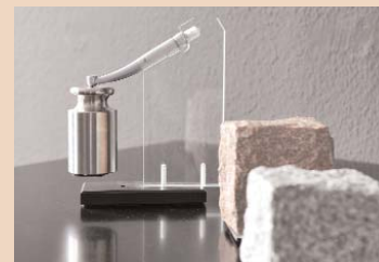
In der KaVo Erlebniswelt: Ein Spannzangengriff muss das Gewicht eines Pflastersteines halten.
