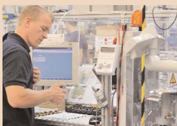
Die Prüfung auf elektrische Sicherheit ist eine von vielen nach jedem Montageschritt.
