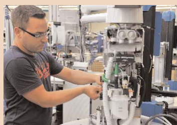
Die Einheiten werden nach dem Prinzip der Fließfertigung montiert.
