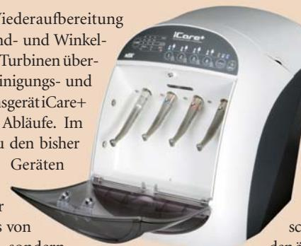
ohne Risiko entsorgt werden. Sie werden nacheinander unter Druck und Rotation in die Instrumente injiziert. Ebenso wirken die Produkte zuverlässig nach automatischer Applikation auf den äußeren Oberflächen der dentalen Übertragungsinstrumente. Den Abschluss eines jeden Aufbereitungzyklus stellt die Ölspülung dar, die aus einem separaten Öltank, der ins Gerät integriert ist, gespeist wird.
