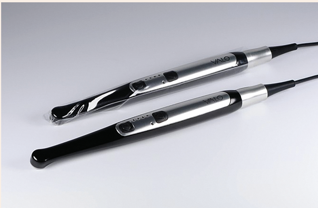
Abb. 3: Auch nach über zehnjähriger täglicher Nutzung und konsequenter Wischdesinfektion nach jeder Behandlung zeigen sich beide Leuchten äusserlich in einwandfreiem Zustand. Bei der oberen VALO™ Polymerisationsleuchte ist die übergestreifte Schutzhülle erkennbar.
