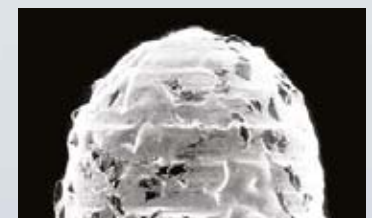
Benutzte galvanisierte Bohrerspitze
