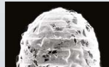
Benutzte galvanisierte Bohrerspitze
