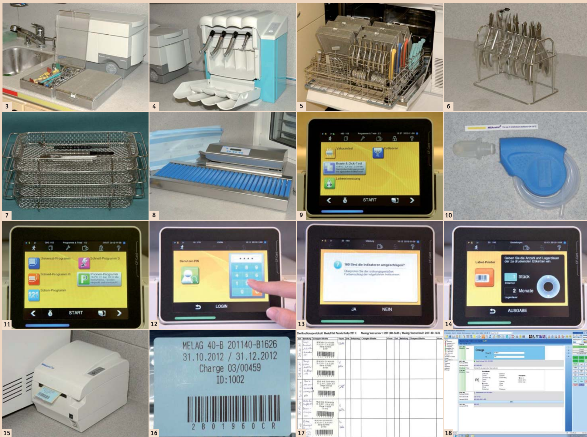
Abb. 3: Reinigungs-Instrumentenbehälter mit Deckel vor Ultraschallbad (COLTENE: Biosonic UC100 für Einzelinstrumente und UC300 für Kassetten/Körbe). – Abb. 4: Pflege- und Reinigungssystem für Winkelstücke (KaVo: QUATTROcare). – Abb. 5: Haltesystem für Saugkanülen: Reinigung von innen und außen. – Abb. 6: Reinigungs-Haltesystem für Zangen für Ultraschall und Thermodesinfektor. – Abb. 7: Offene, stapelbare Instrumentenkörbe. – Abb. 8: Folienbeutel-Schweißsystem (MELAG: MELAseal Pro). – Abb. 9: Prüfprogramme am Autoklaven (MELAG Vacuclav 40B+). – Abb. 10: Prüfkörper für den „Bowie & Dick-Test“. – Abb. 11: Touchscreen am Autoklaven für die Dateneingabe: Programmwahl für die manuelle Dateneingabe und Anzeige der jeweiligen Traybestückungen. – Abb. 12: Eingabe des persönlichen Identifikationscodes. – Abb. 13: Bestätigen des Farbumschlages des Indikators. – Abb. 14: Eingabe der Etikettendaten. – Abb. 15: Etikettendrucker MELAprint 60. – Abb. 16: Chargen-Einfach-Klebeetiketten (blau). – Abb. 17: Manuelle Beladungsliste mit Chargenetiketten. – Abb. 18: Chargendaten in der elektronischen Krankengeschichte (Beispiel: ZaWin4).
