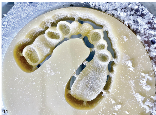
Abb. 13: Die einzelnen, taktil gescannten Stümpfe. – Abb. 14: Gefräster Prototyp auf Basis des Vorscans zur Kieferrelationsbestimmung. – Abb. 15: Fertige Sekundär- und Gerüstkonstruktion als Einstückfräsung.
