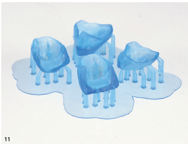
Abb. 11: Formvorlage der Veneers gedruckt mit Inova Print Ocean Blue (HPdent). – Abb. 12: Frontzahnveneers und Seitenzahnkronen auf dem Oberkiefermodell.
