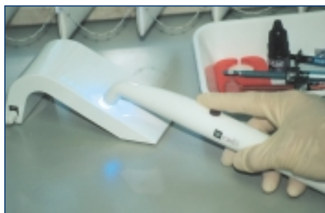
(Abb. 5) 4 Eingebautes Radiometer in der Basisstation.
