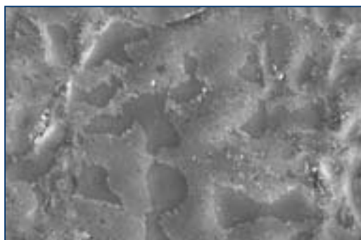
(Abb. 2) ▶ Rasterelektronenmikroskop-Aufnahme einer angeätzten VITAVM 7 Oberfläche (Vergrößerung 5.000 x).
